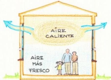
Techos altos para alejar el aire caliente
