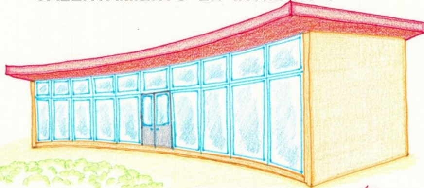
Fachada acristalada orientada al sur
