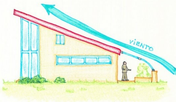
Cubierta que haga resbalar los vientos
